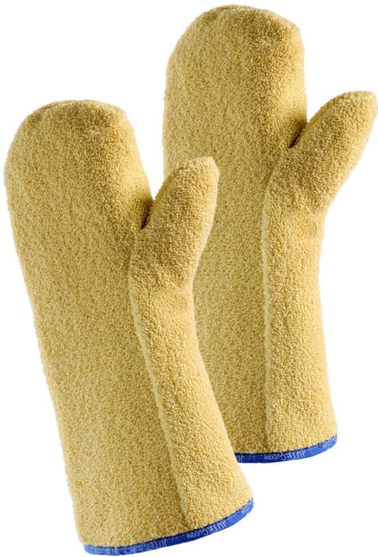
Diese Handschuhe aus Aramid-schlingengewebe sind ideal für Arbeiten mit heißen scharfkantigen Teilen, die nicht wärmer als 500°C sein dürfen. Besonders ist auf das Eigengewicht des zu transportierenden Werkstückes zu achten, welches Einfluss auf den Hitzedurchfluss nimmt. Ideal bei Arbeiten mit vorgewärmten Blechen z. B. an Stanzpressen.
